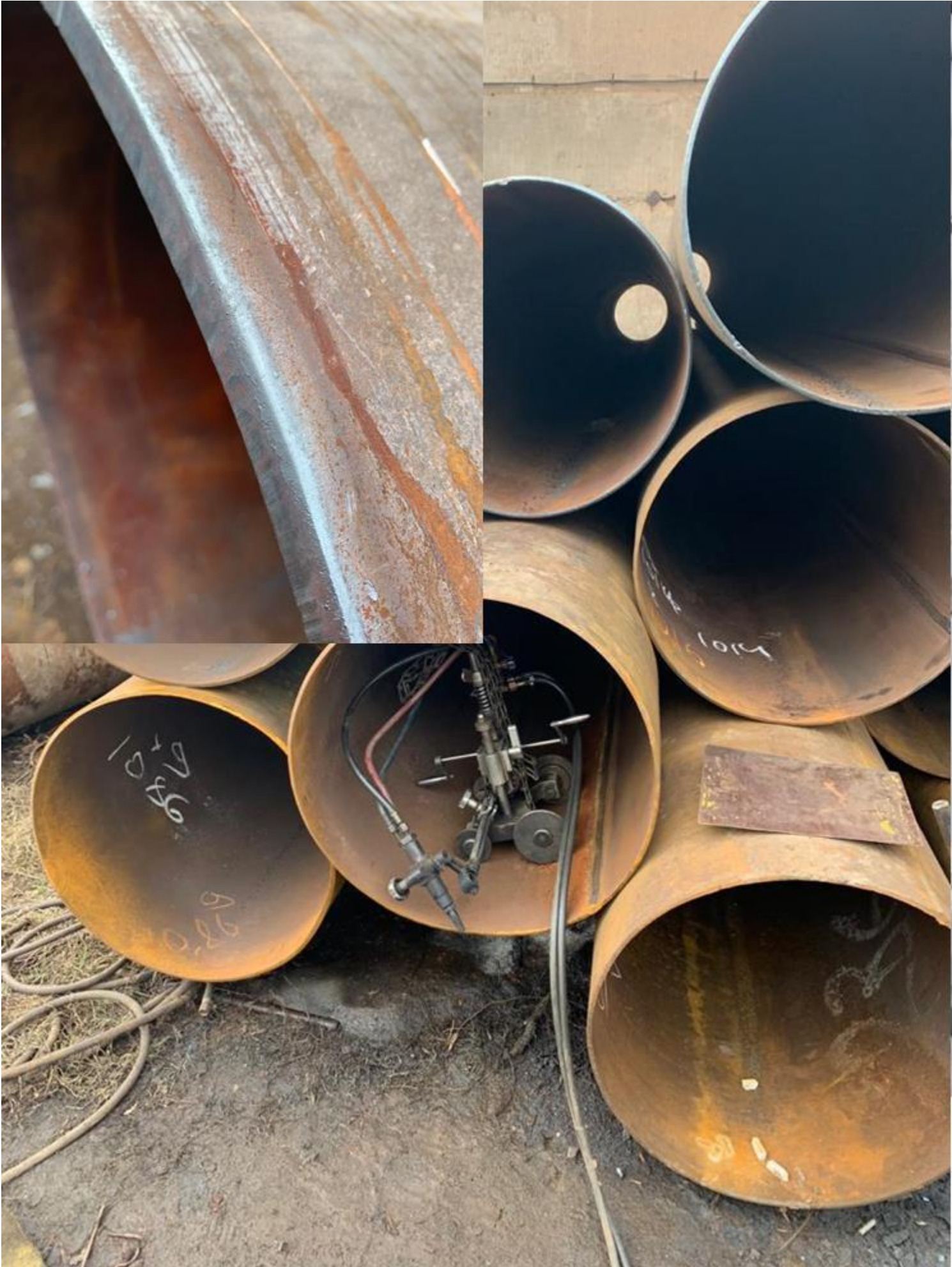
№3 Труба, восстановленная \varnothing 219-1420 мм (шовная/ бесшовная). Наружная и внутренняя поверхности подвергаются пескоструйной обработке, концы заторцованы)
