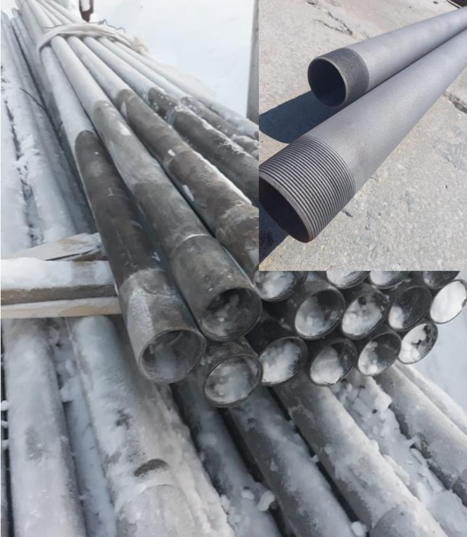
№2 Труба бесшовная (тело трубы НКТ, без муфт), восстановленная Ø73 мм стенка 5,5мм. Наружная и внутренняя поверхности подвергаются пескоструйной обработке)
